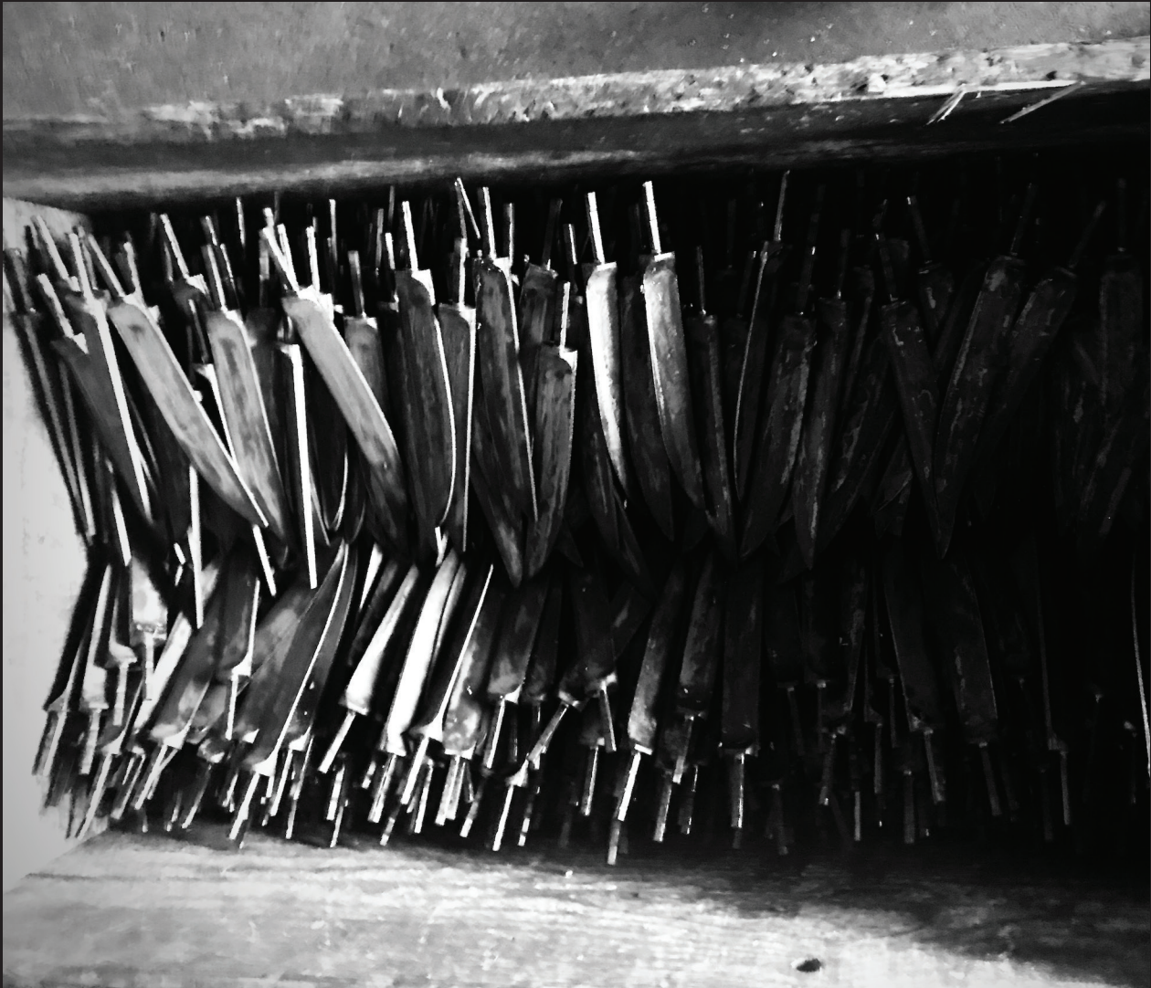
Lames prêtes à être traitées puis assemblées Forges foréziennes - 2019
